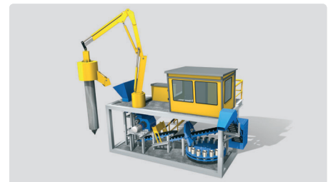
Получение проб из грузовых автомобилей или железнодорожных вагонов посредством шнековой заборной установки на гидравлической стреле
